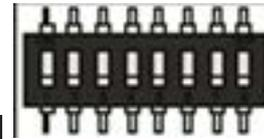
주소가 할당되어 있습니다. 이 주소는 시운전 중에 DIP 스위치 로 설정합니다. DIP 스위치에는 8개의 토글 스위치가 있습니다. 처음 3개의 토글 스위치(1-3)로 구역 번호를 설정할 수 있습니다. 우측의 마지막 5개 토글 스위치(4-8)를 통해 스마트 스위치의 고유한 ID 번호를 설정할 수 있습니다.
